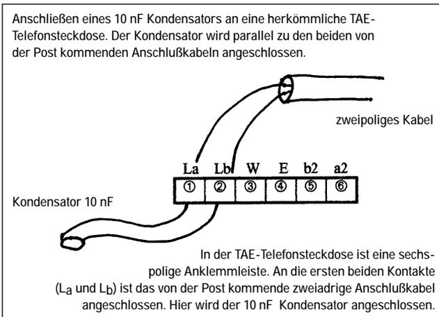
schengeschaltet wird. Eine weitere Möglichkeit ist, im Stecker oder der Steckdose des Apparats einen Kondensator (10nF) anzubringen. Dadurch wird bewirkt, daß das zum Abhören erforderliche Signal in der Leitung kurzgeschlossen wird. Solch ein Kondensator kostet knapp eine Mark.
